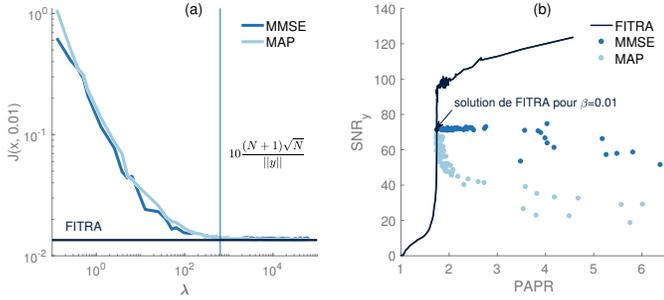
FIGURE 2 – (a) Valeurs de  $J(\hat{x}, 0.01)$  pour les estimateurs MAP et MMSE en fonction de  $\lambda$ . (b) Position des estimateurs MAP et MMSE dans le plan PAPR/SNR<sub>y</sub> en fonction de  $\lambda$ .
